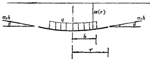
图4 圆环薄膜部份  $b \leq r \leq a$  的平衡图.
