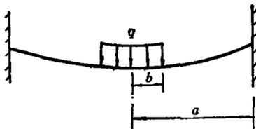
图2 圆薄膜中心部份受均布载荷的问题.
