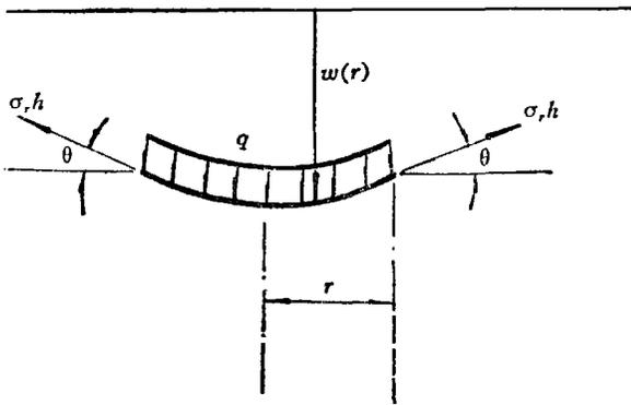
图3 圆薄膜中心部份 ( $r \leq b$ ) 的平衡图.
