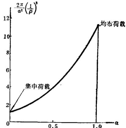
图 5  $\frac{\pi a^2 b^2 q}{h^4 E} / \left( \frac{w_m}{h} \right)^3 = \frac{2\pi}{\alpha^2} \left( \frac{1}{\rho} \right)^3$  和  $\alpha$  的关系曲线.
