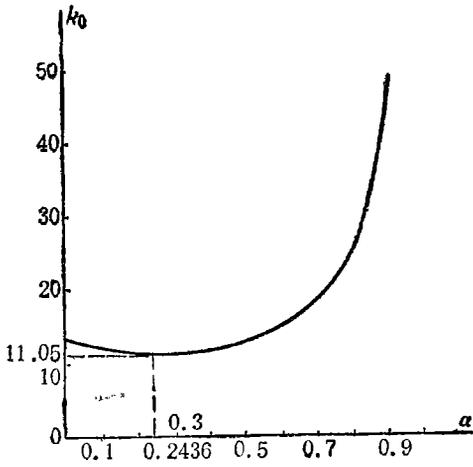
图5 临界几何参数 $k_0$ 与 $\alpha$ 的关系曲线( $\nu=0.3$ )
