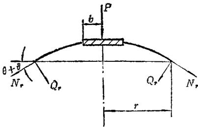
图2 载荷函数  $F(r)$  的确定
