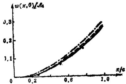
图6  $y=0$  边的挠度  $w$  分布 ( $a/b=1.0$ ,  $P=\text{const}$ ,  $q=0$ )
