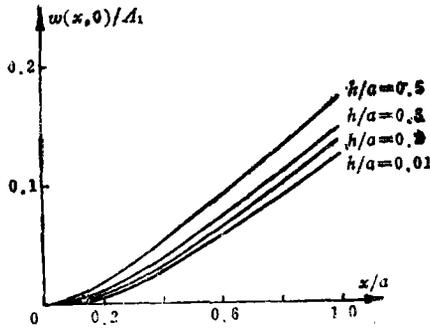
图3  $y=0$  边的挠度  $w$  分布 ( $a/b=1.0$ ,  $q=\text{const}$ ,  $P=0$ )
