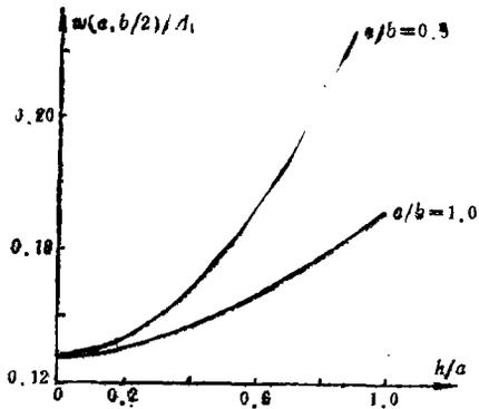
图5  $w$  随  $h/a$  的变化 ( $q=\text{const}$ ,  $P=0$ )
