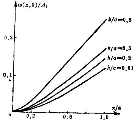
图4  $y=0$  边的挠度  $w$  分布 ( $a/b=0.5$ ,  $q=\text{const}$ ,  $P=0$ )
