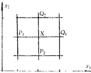
图1  $X$ 点的下坐标近点和上坐标近点
