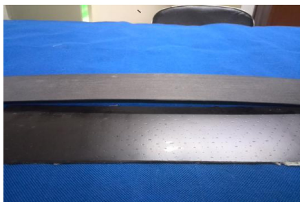
图 18 不同模具上 CFRP 固化后的翘曲
