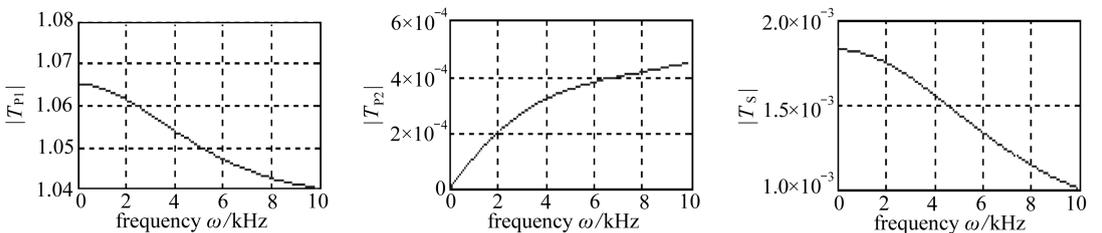
图4 斜入射波在两相饱和和弹性介质自由界面传播的透射系数绝对值及其相位
