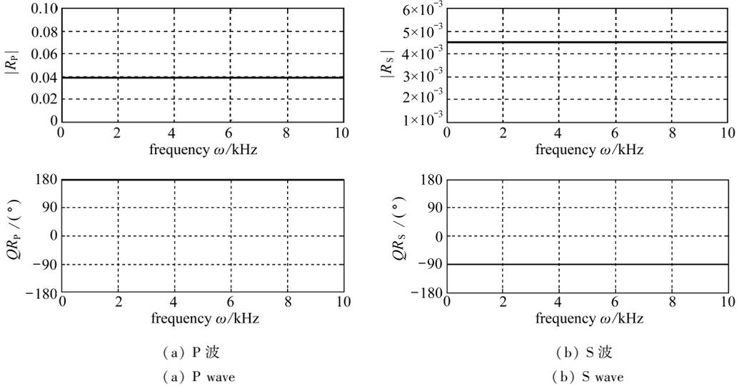
图 7 斜入射波在单相介质层界面传播的反射系数绝对值及其相位
