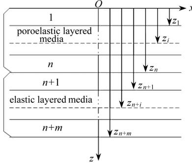
图 1 直角坐标系下多层弹性介质半空间模型
