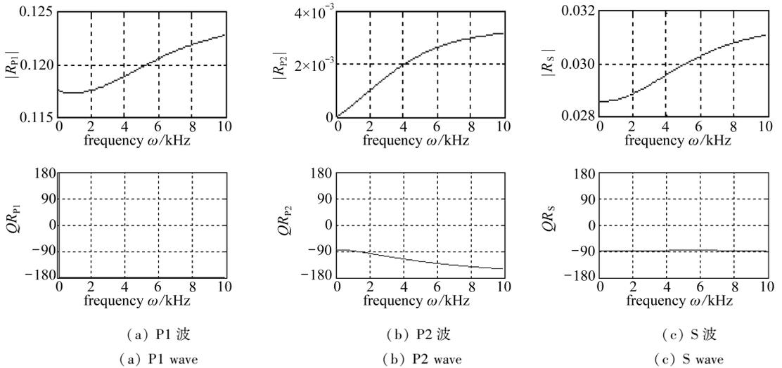
图3 斜入射波在两相饱和和弹性介质自由界面传播的反射系数绝对值及其相位
