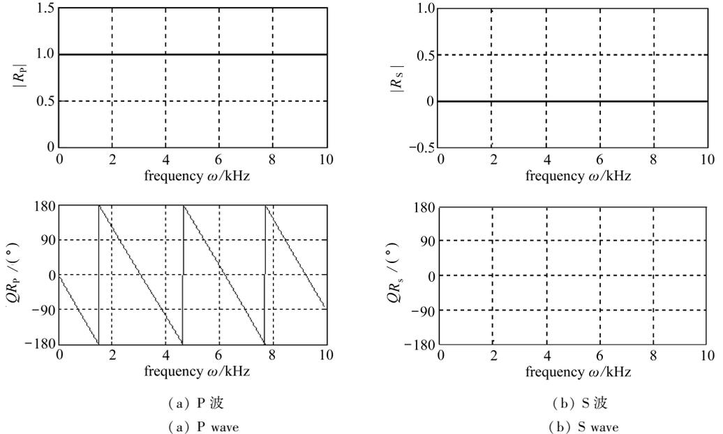
图 10 垂直入射波在单相多层介质中传播的反射系数绝对值及其相位
