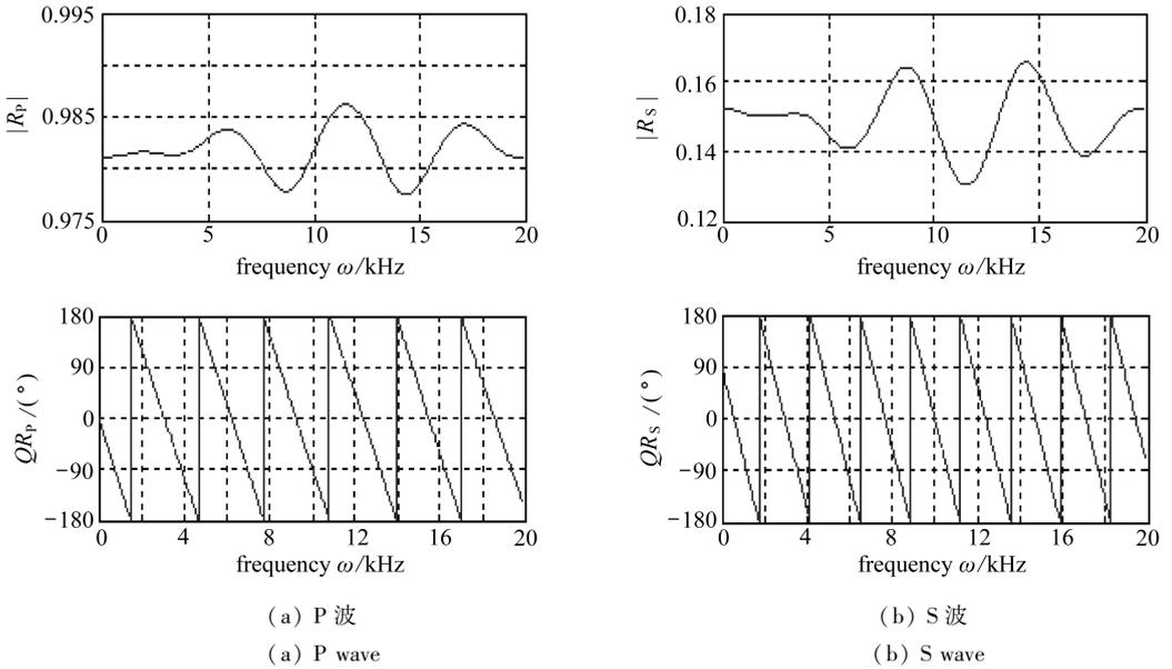
图 9 斜入射波在单相多层介质中传播的反射系数绝对值及其相位
