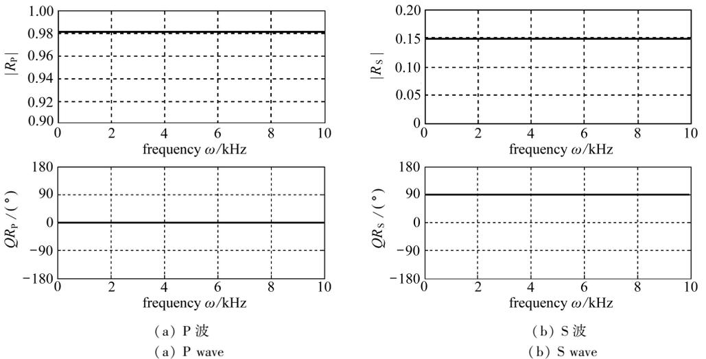
图6 斜入射波在单相介质自由界面传播的反射系数绝对值及其相位
