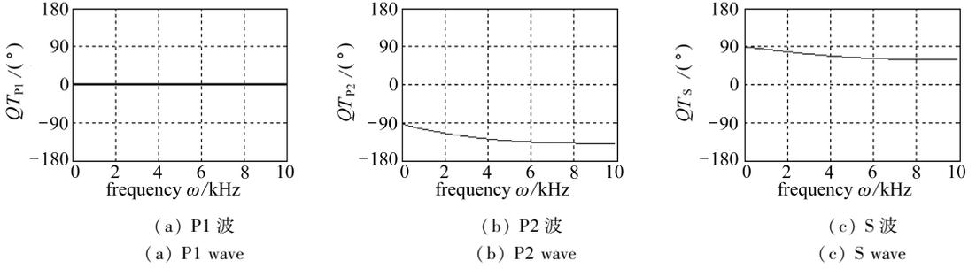
图4 斜入射波在两相饱和介质层界面传播的透射系数绝对值及其相位
