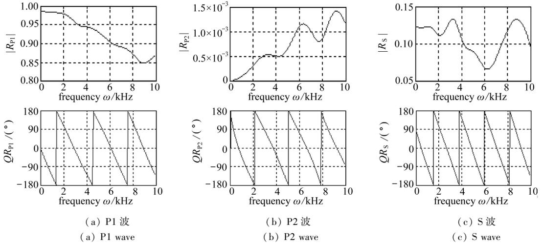
图5 底层入射波在多层两相饱和介质自由界面传播的反射系数绝对值及其相位
