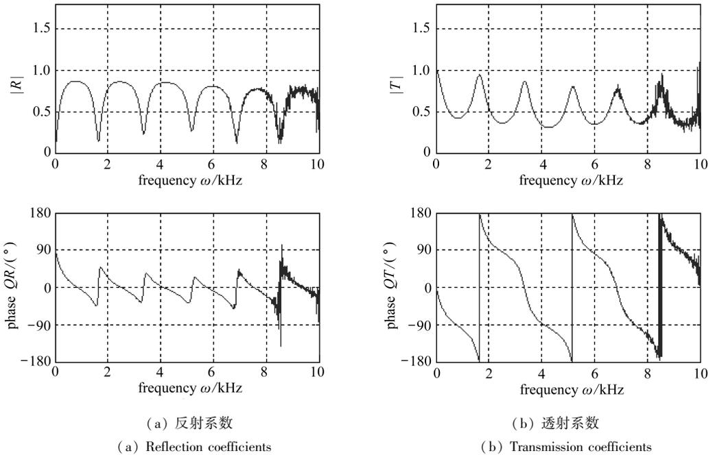
图 11 垂直入射波在顶底面皆流相的两相饱和多层介质中传播的反射与透射系数绝对值及其相位
