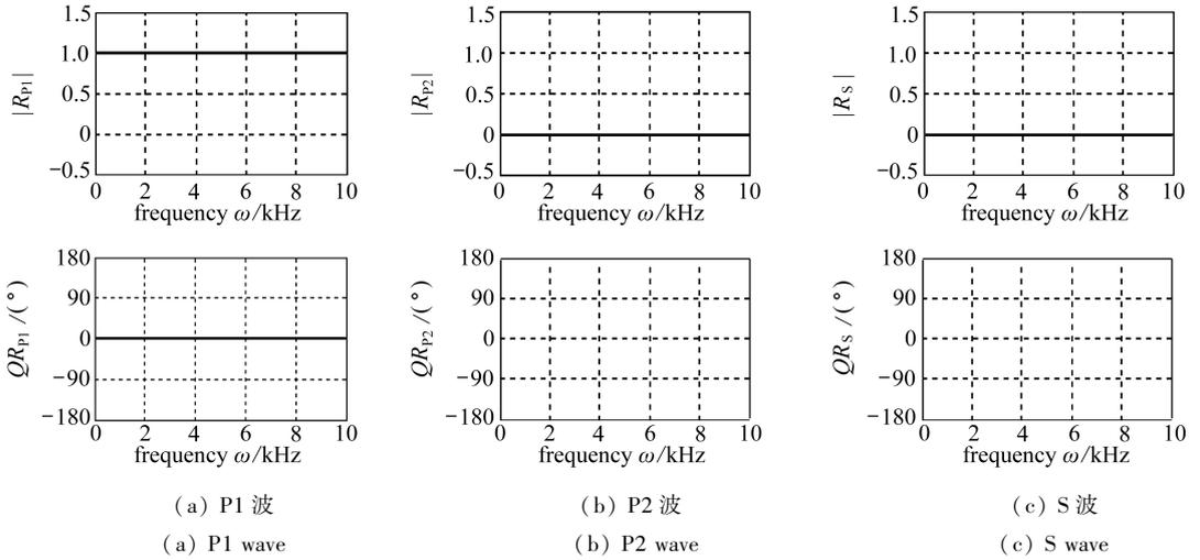
图2 垂直入射波在两相饱和和弹性介质自由界面传播的反射系数绝对值及其相位
