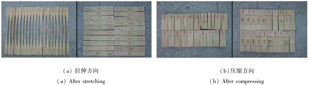
图 1 竹层积材性能实验的试件
