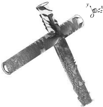
图4 三维等压力面和中心剖面速度矢量计算图
