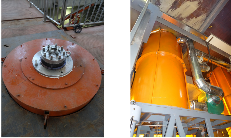
图 14 模拟井筒加热装置
