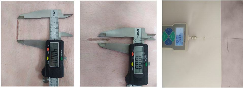
图6 伤口尺寸及缝合力测量方法
